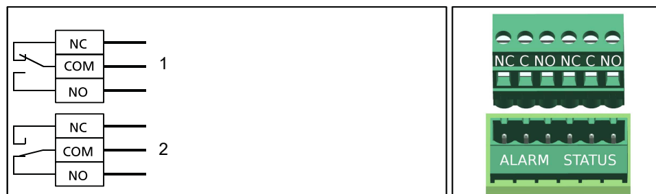
III. 9: Schéma de connexion report de marche
