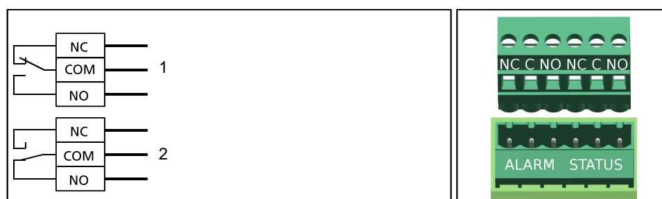
III. 10: Schéma de connexion report centralisé de défaut
